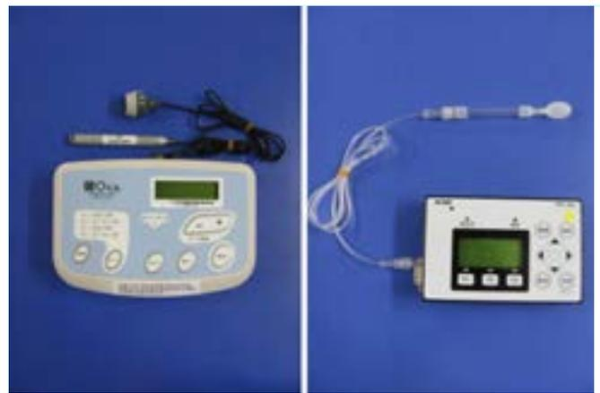
図2. 簡易型舌圧測定装置 (左) と健口くん (右)
