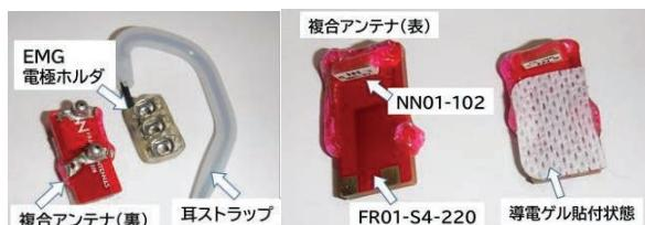
図 1 ノイズ信号用アンテナ
