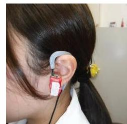
図 2 ノイズ信号用アンテナ装着状態
