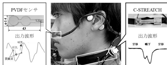
図1 嚥下と呼吸の計測システム
